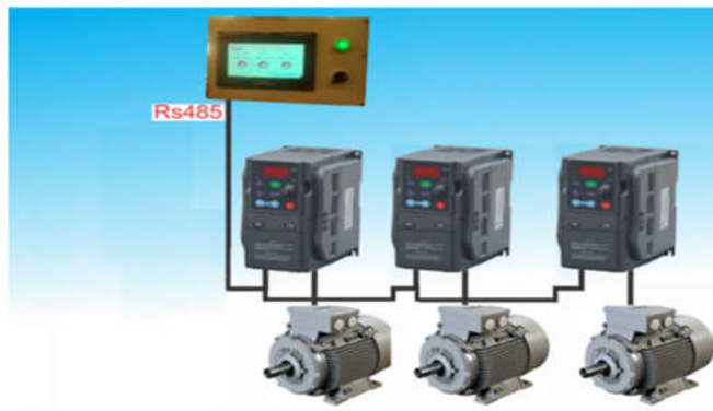
Hình 1. Hình ảnh hệ thống HMI-Biến tần
